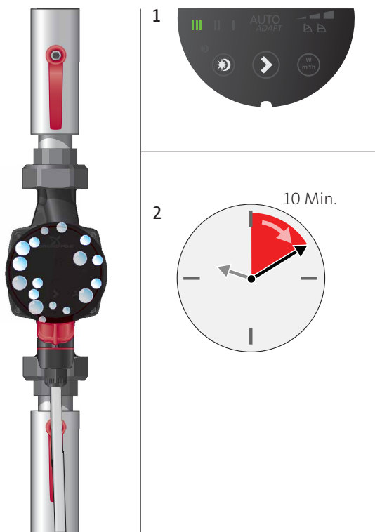
Рис. 25 Удаление воздуха из насоса
