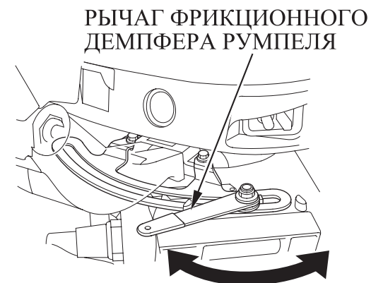
РЫЧАГ ФРИКЦИОННОГО ДЕМПФЕРА РУМПЕЛЯ УВЕЛИЧИТЬ СОПРОТИВЛЕНИЕ (ЗАФИКСИРОВАТЬ) УМЕНЬШИТЬ СОПРОТИВЛЕНИЕ (ОСВОБОДИТЬ) (Модификация Н)
