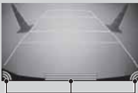
Индикаторы указывают, где расположен датчик, обнаруживший препятствие.
