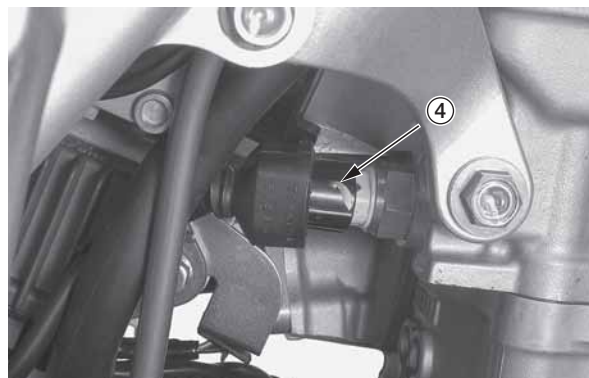
(4) разъем датчика температуры двигателя
