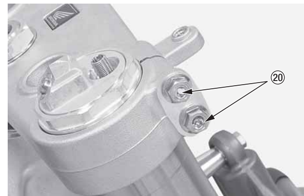
(20) верхние стяжные болты перемычки вилки
