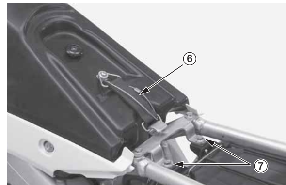
(6) ремень топливного бака (7) крепежные болты воздушного фильтра
