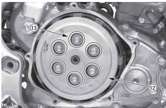
(12) прижимной диск сцепления (13) пружины сцепления и болты
