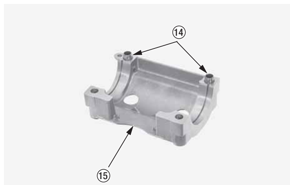
(14) установочные штифты (15) держатель распределительного вала
