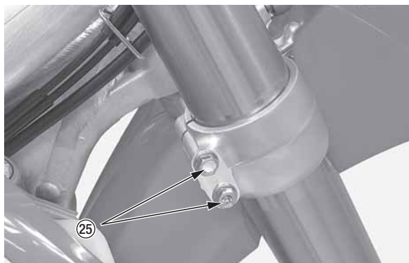
(25) нижние стяжные болты перемычки вилки
