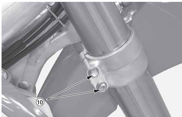
(10) нижние стяжные болты траверсы вилки
