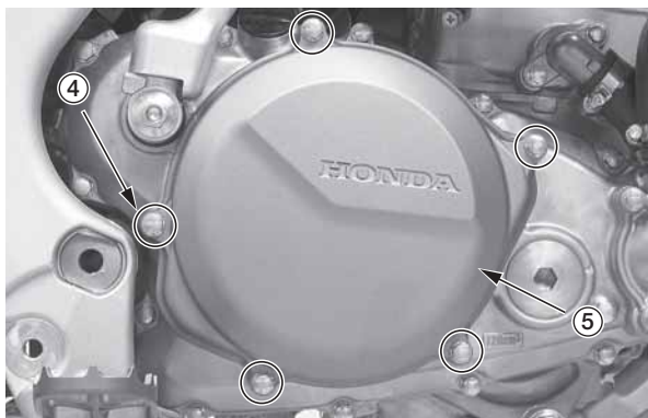
(4) болты кожуха сцепления (5) кожух сцепления
