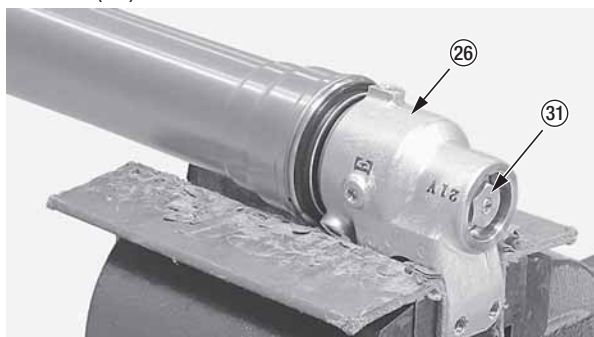
(26) держатель оси (31) центральный болт вилки
