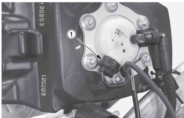
(1) штекер топливного насоса
