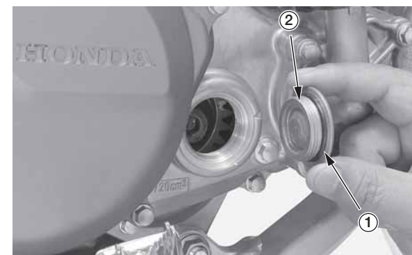
(1) уплотнительное кольцо (новое) (2) крышка контрольного отверстия коленчатого вала
