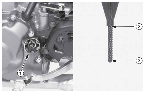
(1) крышка картера/масляный щуп (2) верхняя отметка (3) нижняя отметка
