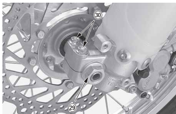
(29) гайка передней оси
