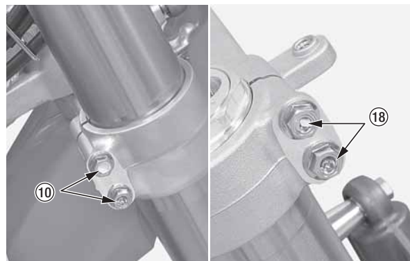
(10) нижние стяжные болты траверсы вилки
