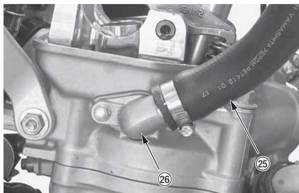
(25) патрубок радиатора (26) головка цилиндра
