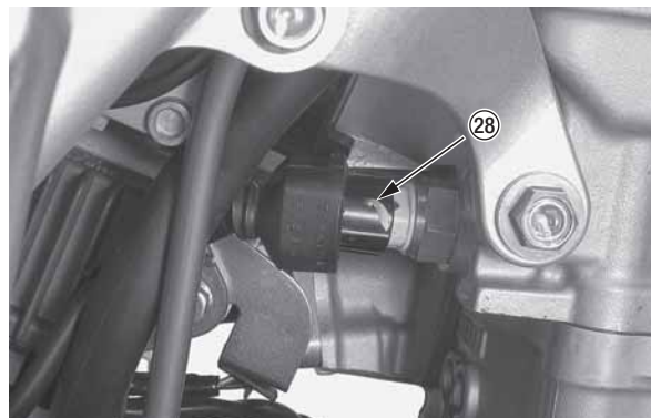
(28) разъем датчика температуры двигателя
