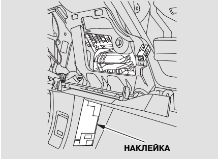
БЛОК ПРЕДОХРАНИТЕЛЕЙ В ПАССАЖИРСКОМ САЛОНЕ
