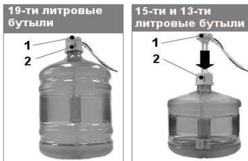
Рис.4. Установка сифона на бутылки с водой
