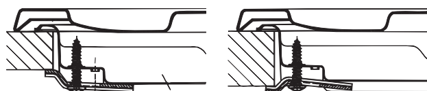
Position der Haken für Arbeitsplatten H=20mm
