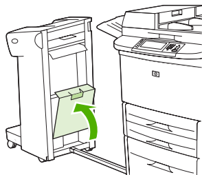
Рисунок 7-5 Загрузка скрепок в шиватель/укладчик (5 из 5)
