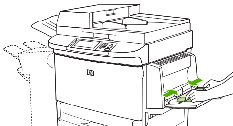
Рисунок 6-3 Загрузка бумаги в лоток 1 (3 из 3)
