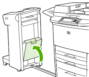
Рисунок 12-60 Устранение замятия скрепок в шивателе/укладчике (8 из 9)
