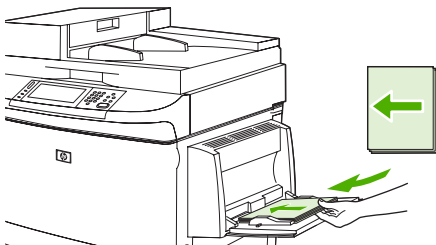
Рисунок 6-2 Загрузка бумаги в лоток 1 (2 из 3)
