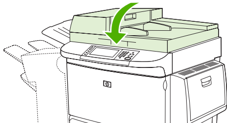
Рисунок 11-12 Очистка системы подачи устройства АПД (5 из 5)
