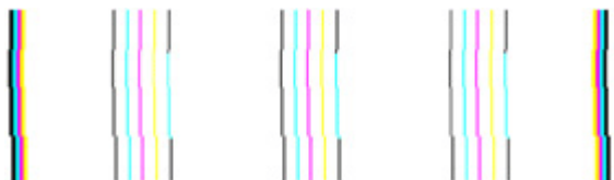
Примеры некачественного выравнивания Линии имеют зубчатые края, выполните выравнивание принтера. Если это не помогло, обратитесь в HP.
