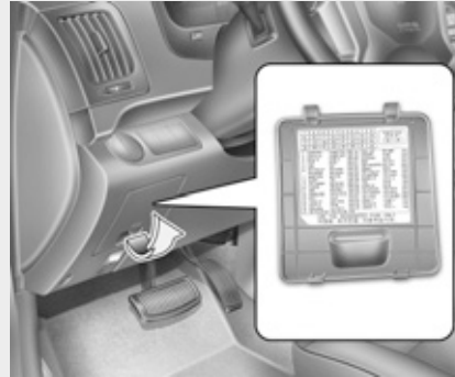
Внутренняя панель плавких предохранителей
