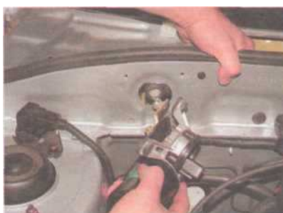
...вставляем шаровой палец кривошипа в отверстие рычага до фиксированного положения. Дальнейшую установку мотор-редуктора очистителя ветрового стекла проводим в обратной последовательности.
