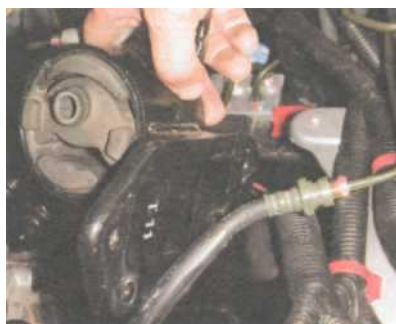
Снимаем левую опору силового агрегата.
