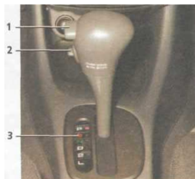
Рычаг выбора передач: 1 — кнопка блокировки перемещения рычага выбора передач; 2 — кнопка «over drive»; 3 — фиксированные положения рычага
