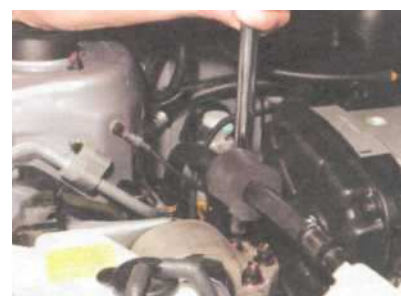
Головкой «на 14» с удлинителем отворачиваем один болт и две гайки крепления опоры к двигателю. Окончательно отвернув болт крепления опоры к кронштейну...
