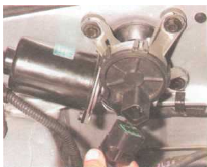
Отсоединяем колодку жгута проводов от мотор-редуктора.
