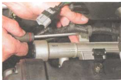
Поддев отверткой два пистона крепления жгута проводов...
