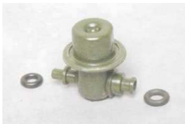
Регулятор давления топлива с уплотнительными кольцами
