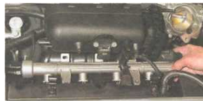
Тянем топливную рампу с форсунками (по оси форсунок), выводя их из отверстий впускного трубопровода.
