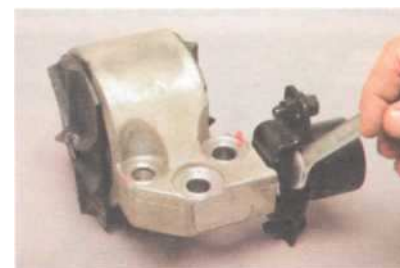
Ключом «на 12» отворачиваем болт крепления кронштейна демпфера к опоре.
