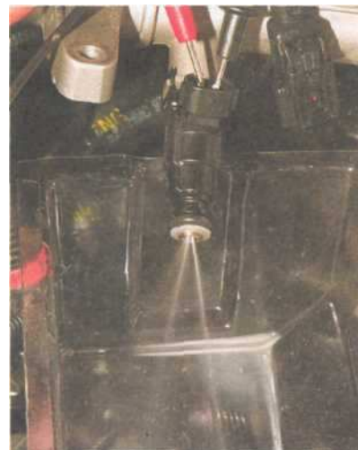
Из распылителя форсунки должны идти струи с характерным конусом распыла.
