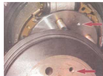
...на совпадение отверстий в ступице и барабане.
