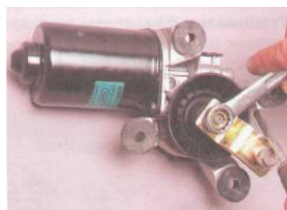
Ключом «на 13» отворачиваем гайку крепления кривошипа, отверткой придерживая его от проворачивания. Снимаем кривошип...
