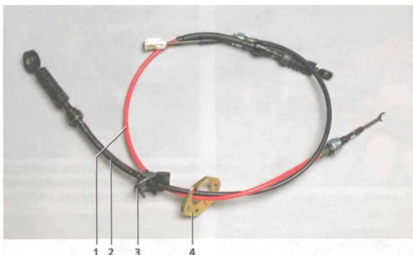
Тросы привода управления коробкой передач: 1 — трос выбора передач; 2 — трос включения передач; 3 — резиновый уплотнитель; 4 — прижимная пластина
