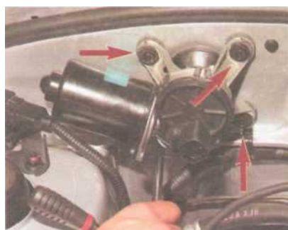
Головкой «на 10» с удлинителем отворачиваем четыре болта крепления мотор-редуктора. Вытягивая на себя мотор-редуктор, освобождаем шарнир кривошипа и снимаем мотор-редуктор.
