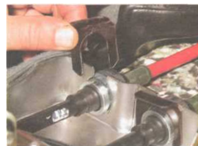
Тросы привода управления коробкой передач: 1 — трос выбора передач; 2 — трос включения передач; 3 — резиновый уплотнитель; 4 — прижимная пластина
