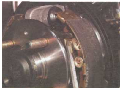
Поддев отверткой, отсоединяем от рычага регулятора верхний конец его пружины ...
