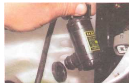
Снимаем электронасос с бачка. Устанавливаем электронасос омывателя ветрового стекла в обратной последовательности.
