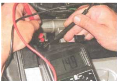
Измеряем сопротивление между выводами форсунки.
