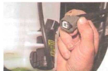
...отсоединяем колодку проводов от электронасоса омывателя ветрового стекла.
