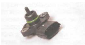
Датчик абсолютного давления и температуры воздуха во впускном трубопроводе
