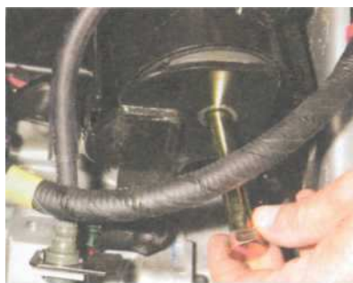
Вынимаем болт крепления опоры к кронштейну.
