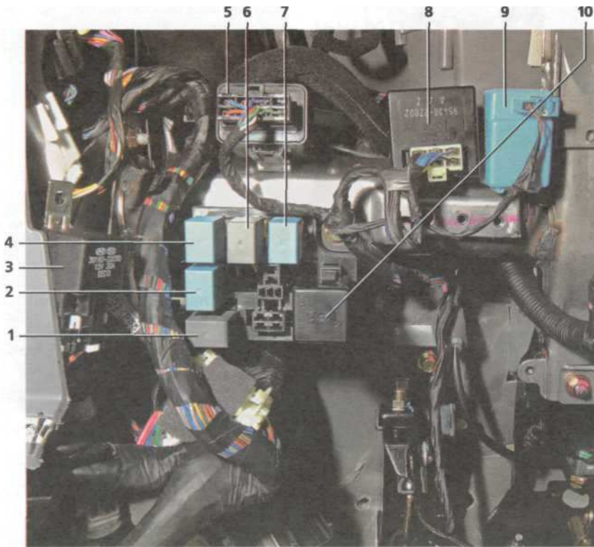
Блок реле в салоне: 1 — реле электронного распределения тормозных усилий (EBD); 2 — реле противотуманного света в задних фонарях; 3 — главное реле системы управления двигателем (для наглядности крепление отсоединено); 4 — реле ламп головного света; 5 — реле очистителя и омывателя ветрового стекла; 6 — реле АБС; 7 — реле электростеклоподъемников; 8 — реле обогрева заднего стекла; 9 — реле звукового сигнализатора; 10 — реле указателей поворота и аварийной сигнализации
