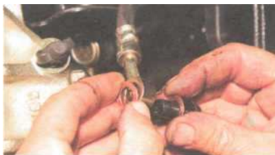
Место установки выключателя сигналов торможения: 1 — колодка проводов выключателя; 2 — держатель проводов; 3 — выключатель сигналов торможения; 4 — контргайка; 5 — кронштейн; 6 — упор педали тормоза
