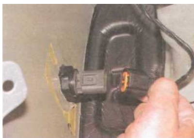
...отсоединяем от патрона указателя колодку проводов.
