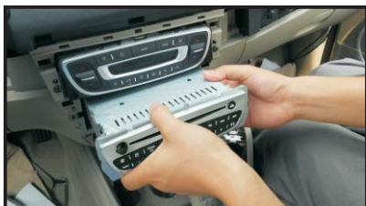
5. Выньте оригинальный DVD-дисковод. Храните крепеж (скобы) отдельно от CD-дисковода.
