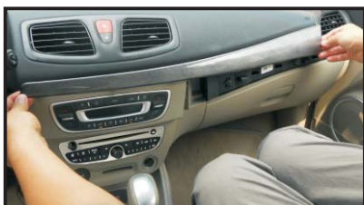
5. Снимите декоративную панель, как показано на фото.
