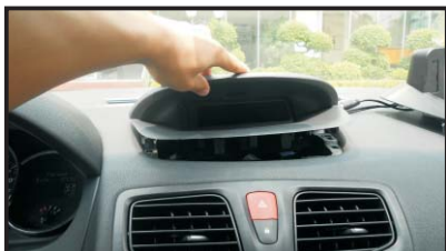
3. Отсоедините проводку. Металлический крепеж храните отдельно от дисплея.
