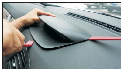
2. Демонтируйте дисплей автомагнитолы.
