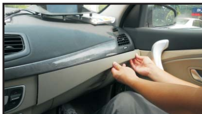
2. Снимите панель над перчаточным отделением.
