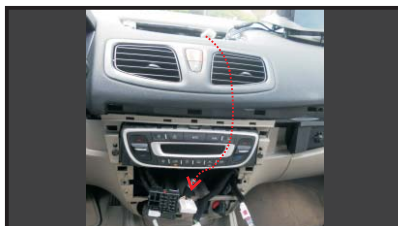
6. Отсоедините DVD-разъем, как показано на фото (внутри приборной панели).
