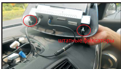
17. Закрепите фиксаторы на мониторе, подсоедините провод IPOD.
