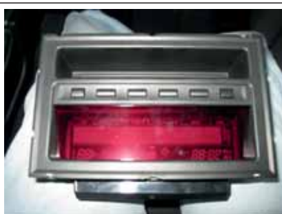
Штатный модуль бортового компьютера, на нем размещен блок электронного компаса.
