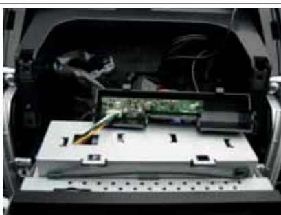
Используя размер головного устройства подключаем компас.
