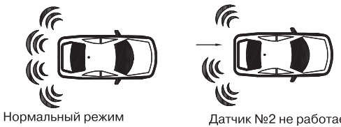
Рис. 2. Сектора сканирования датчиков
