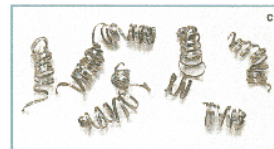
Свободно намотанная (витая) стружка - идеальные условия резания
