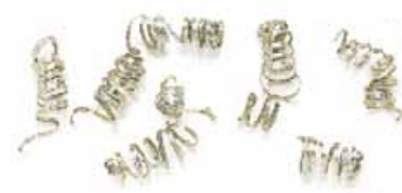
Свободно намотанная (витая) стружка идеальные условия резания
