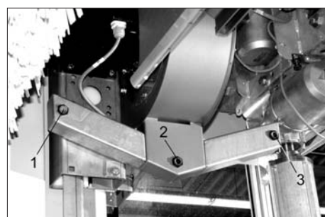
Figure 9 1 Barrage photo-électrique - séchoir à l'avant 2 Barrage photo-électrique - séchoir au milieu 3 Barrage photo-électrique - séchoir à l'arrière
