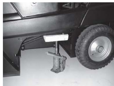
Точка установки домкрата (задние колеса)
