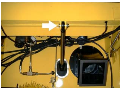
– Подъемный цилиндр и выдвигаемые штанги
