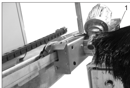
Obr. 3 1 Koncový spínač střešního kartáče nahoře (SKN)
