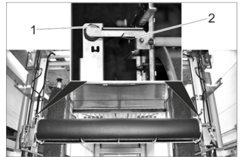
صورة 8 1. المفتاح الحدي لمفتاح أمان كمره سقف الضغط العالي 2. نابض
