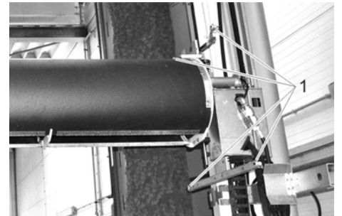
صورة 9 1. حواجز ضوئية لكمره سقف الضغط
