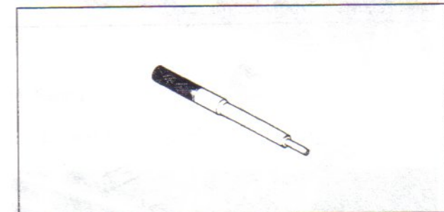
Valve Guide Reamer, \phi 5 : 57001-1204
