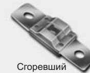
Сгоревший предохранитель 1VQA4037
