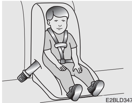
Установка системы детского сиденья с помощью поясного ремня безопасности (на центральном заднем сидении)
