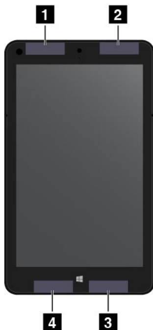
Рис. 5. Расположение антенн беспроводной связи UltraConnect
