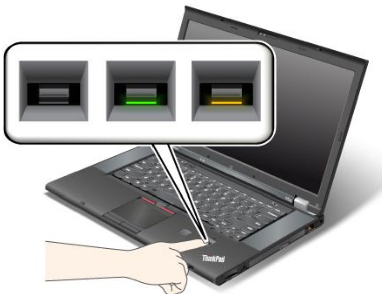
Табл. 4. Состояние индикаторов устройства распознавания отпечатков пальцев
