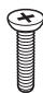
Суурилуулах боолтнууд 4EA, M4 x L10 (Зөвхөн LB70**, LB72**, LB73** -ZD/ZE) (Хар х. А-6)
