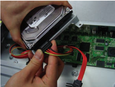
&lt;Подключение кабеля питания&gt;
