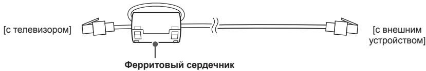
[Вид ферритового сердечника в разрезе]
