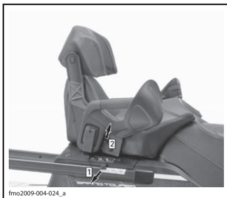
Шаг 1: Потяните резиновый фиксатор Шаг 2: Поднимите правую часть крышки
