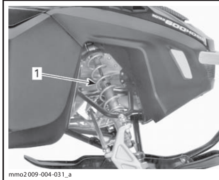
ТИПОВОЙ ВАРИАНТ — ПЕРЕДНЯЯ ПОДВЕСКА 1. Передние пружины — управляемость
