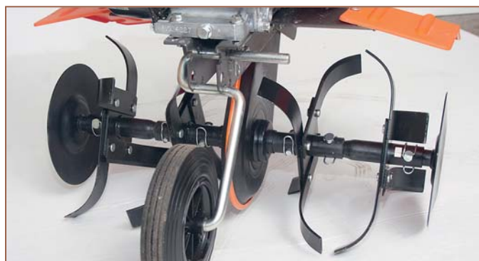
Редуктор в неразборном корпусе, транспортировочное колесо опущено. Четыре фрезы и два диска для защиты растений, соединяющихся с помощью стальных пальцев с полукруглыми защёлками, — полный комплект для обработки почвы
