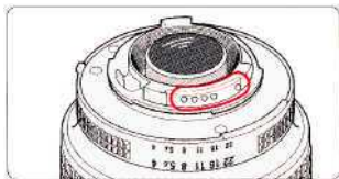
Контакты микропроцессора на объективе со встроенным микропроцессором
