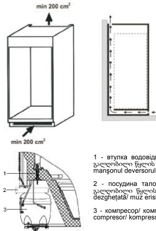
Рисунок Б.4 - Схема відведення талої води з холодильної камери/ Рисунок Б.4 - Схема отвода талой воды из холодильной камеры/ ნახაზი Б.4 - სამაცივრე კამერიდან გაღლობილი წყლის გადმოღვრის სქემა/ Şekil B. 4 - Soğuducu kameradan erimish suyun axma sxemi/ Б.4-сурет - Тоңазытқыш камерадағы еріген судың ағу сызбанұсқасы / Figura B.4 - Schema scurgerii apei dezghețate din camera frigorifică/ B.4-rasm: Muz erishidan hosil bo'lgan suvni sovutish kamerasidan chiqarib tashlash chizmasi.
