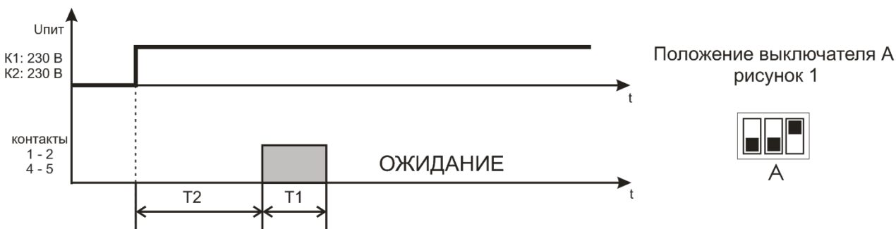
Рисунок 3 – Алгоритм работы реле “Импульсный 1”
