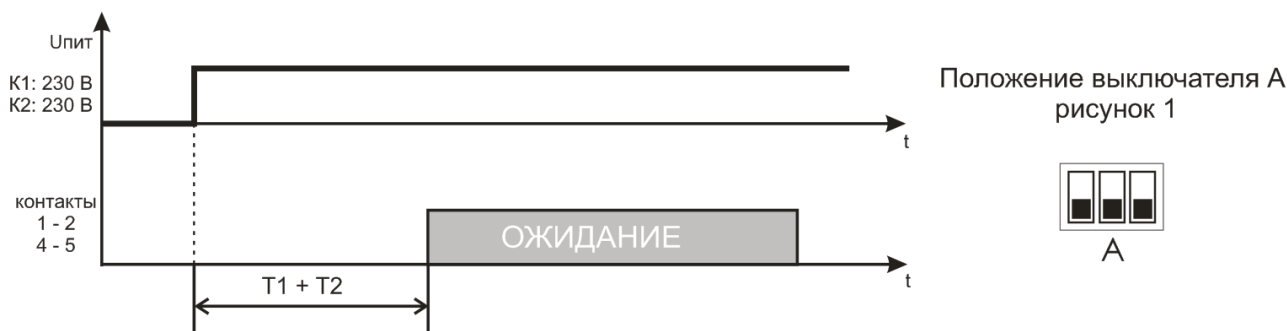
Рисунок 2 – Алгоритм работы реле “Задержка на включение”
