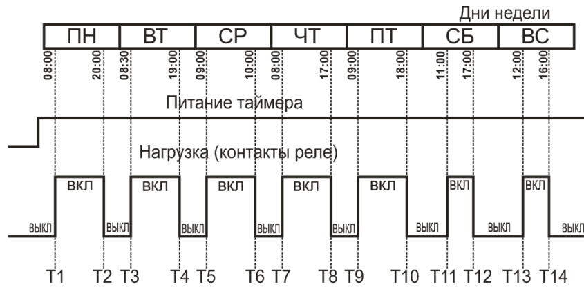
Рисунок 3.4 – Включение нагрузки на примере недельного режима работы
