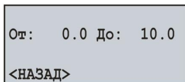
Рисунок 7.2.5 – Экран настройки масштаба датчика аналогового напряжения
