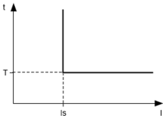
Рисунок 1.2 - Принцип защиты с независимой выдержкой времени
