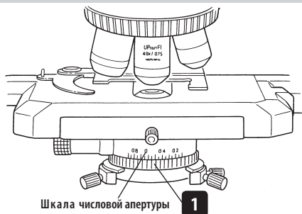
Рис. 9 Перемещение изображения ирисовой диафрагмы осветителя микроскопа
