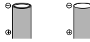
Батареи с плоскими полюсами без защитной оболочки. (Батареи этого вида не разрешается использовать, даже если отрицательный полюс частично закрыт.)
