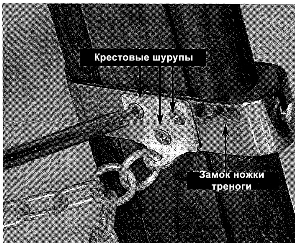
Рисунок 3. Используйте крестовую отвертку для прикручивания латунных креплений цепи к замкам ножек треноги.
