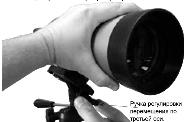
Рисунок 7. Третья ось перемещения треноги используется очень редко или вообще не используется.
