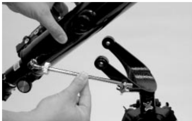
Рисунок 4. Установка оптической трубы в хомут.
