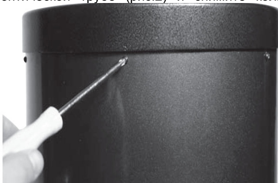
Рисунок 2. Чтобы снять кольцо с тыльной стороны, открутите шесть винтов, крепящих его к оптической трубе.
