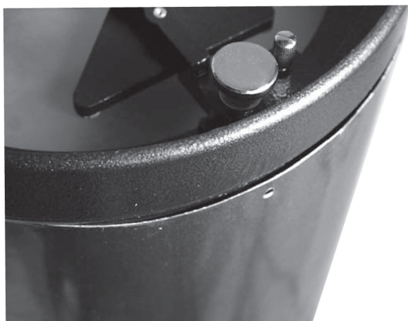
Рисунок 7. Найдите выпуклость на трубе, предохраняющую корпус первичного зеркала от полной посадки на место.
