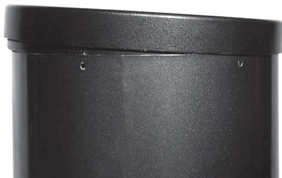
Рисунок 6. Опустите собранный корпус зеркала на оптическую трубу, так чтобы одна сторона кольца улеглась на край трубы. Монтажные отверстия с резьбой должны быть вровень со сквозными отверстиями на тыльной стороне трубы.
