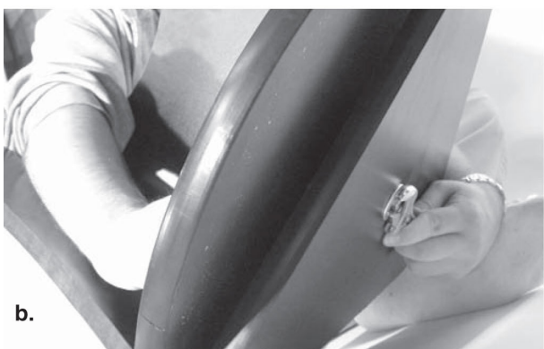
Рисунок 11. Для соединения оснований, слегка наклоните их, как показано. Не кладите их полностью (а). Удерживайте шестигранный болт ключом с одной стороны (б), одновременно поворачивая другой конец винта азимутальной оси.
