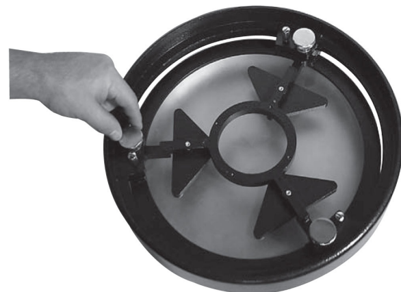
Рисунок 26. Наклон первичного зеркала регулируется поворотом одного или нескольких больших болтов.
