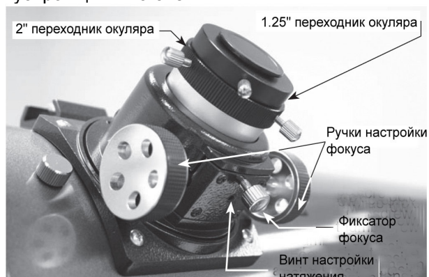
Рисунок 20. 2" фокусировщик Крэйфорда телескопа SkyQuest XT12.
