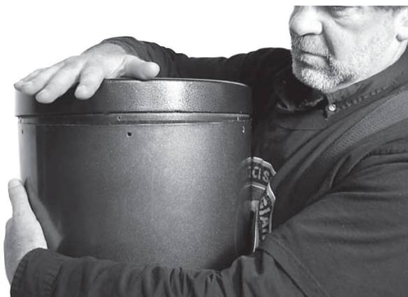
Рисунок 8. Обхватите оптическую трубу, повернув выпуклой стороной к себе и легкими постукиваниями усадите корпус зеркала на трубу.
