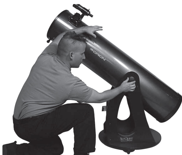
Рисунок 29. Вращайте ручку натяжения до тех пор, пока телескоп не будет сбалансирован по высоте. Телескоп при этом должен легко двигаться, не смещаясь в сторону, когда Вы его отпускаете.
