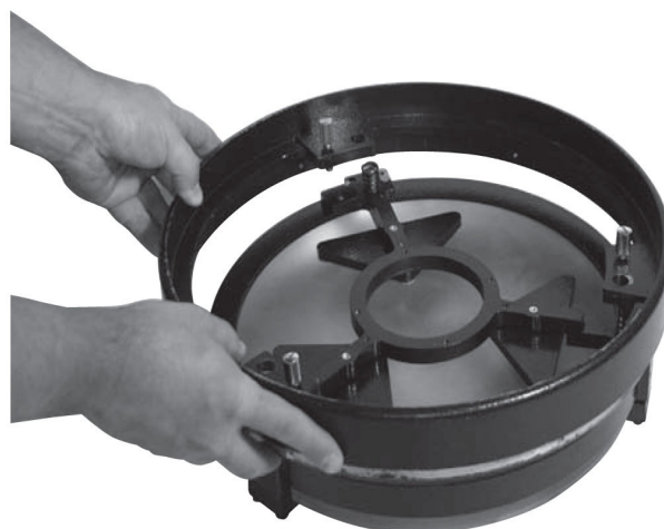
Рисунок 4. Опустите кольцо на корпус зеркала так, чтобы стержни с резьбой оказались внутри кольца и кольцо легло на пружины.
