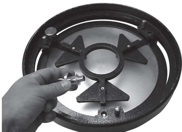
Рисунок 5. Накрутите коллимационные винты с нейлоновыми шайбами внутри кольца на стержни с резьбой. Винты должны быть закручены минимум на три полных оборота.
