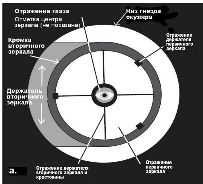
Рисунок 21. Коллимирование оптики. (а) Если зеркала выровнены надлежащим образом, Вы должны увидеть похожую картинку. (b) С установленной коллимационной крышкой, если оптика не выровнена, изображение будет выглядеть так. (с) Здесь, вторичное зеркало центрировано, но требуется отрегулировать его наклон, чтобы видеть отражение основного зеркала. (d) Вторичное зеркало окончательно выровнено, но основное зеркало нуждается в регулировке. Когда оно будет выровнено, "точка" будет находиться точно в центре (е).
