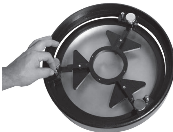
Рисунок 25. Прежде чем что-либо регулировать, сначала нужно ослабить три маленьких винта, удерживающих первичное зеркало.
