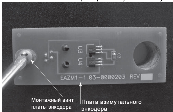
Рисунок 10. Установка платы азимутального энкодера. Выставьте на одной оси большое отверстие в плате энкодера и центральное отверстие верхнего основания
