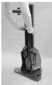
Рисунок 5. Установите оптическую трубу на основание, так чтобы высотные боковые опоры встали на белые пластиковые подкладки. Установите телескоп, как показано на рисунке, так чтобы он не упал, прежде чем будет установлена и настроена система CorrecTension.
