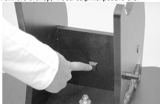
Рисунок 3. Приклейте резиновый стопор поверх специальной метки на внутренней поверхности передней скобы.
