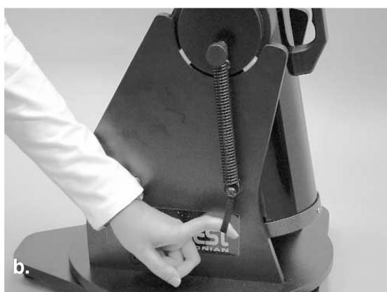
Рисунок 7: (а) Для установки пружины, потяните за петлю пальцем вниз. (б) Накиньте петлю пружины на головку болта и на нейлоновую прокладку и отпустите петлю.
