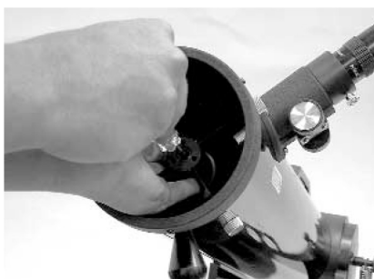
Рисунок 17. Для центрирования вторичного зеркала под фокусировщиком, отрегулируйте центральный винт крестовой отверткой, удерживая пальцами держатель зеркала. Не касайтесь поверхности зеркала.
