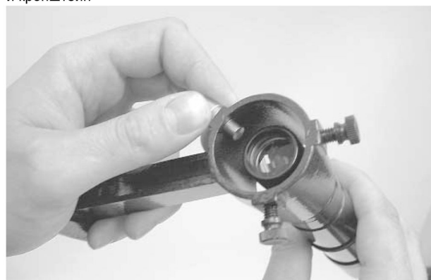
Рисунок 8б. Вставка искателя в кронштейн.
