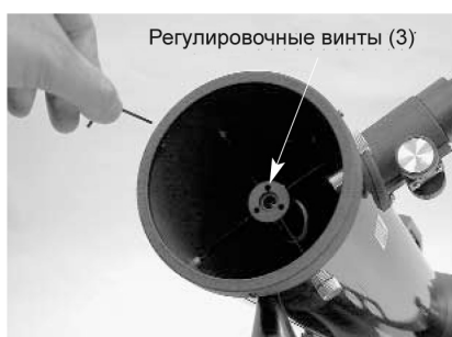
Рисунок 18. Отрегулируйте наклон вторичного зеркала, ослабляя или затягивая регулировочные винты 2 мм шестигранником.
