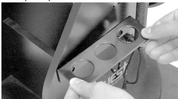
Рисунок 4. Используя два шурупа из комплекта, установите алюминиевую раму для окуляров в высверленные на заводе отверстия примерно посередине левой боковой панели.
