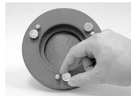
Рисунок 20. Наклон первичного зеркала регулируется поворотом одного или нескольких больших болтов.
