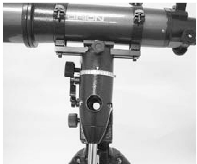
Рисунок 12. Для того чтобы смотреть в полярноосевой искатель, оптическая труба должна быть под углом 90^\circ к оси прямого восхождения.
