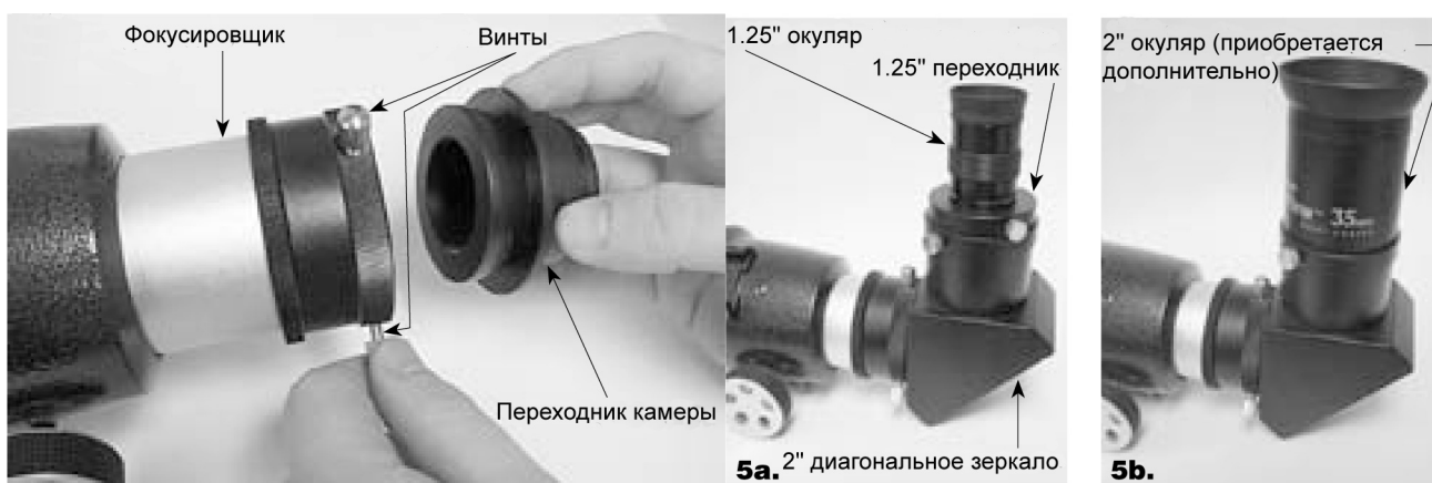
Рисунок 4. Перед установкой 2" диагонального зеркала снимите сначала переходник камеры.
