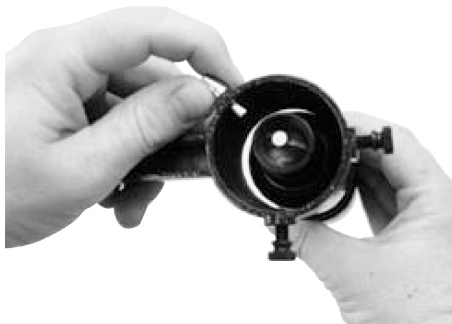
Рисунок 3б. Оттяните натяжитель и вставляйте искатель до тех пор, пока О-кольцо не окажется в кольце кронштейна.
