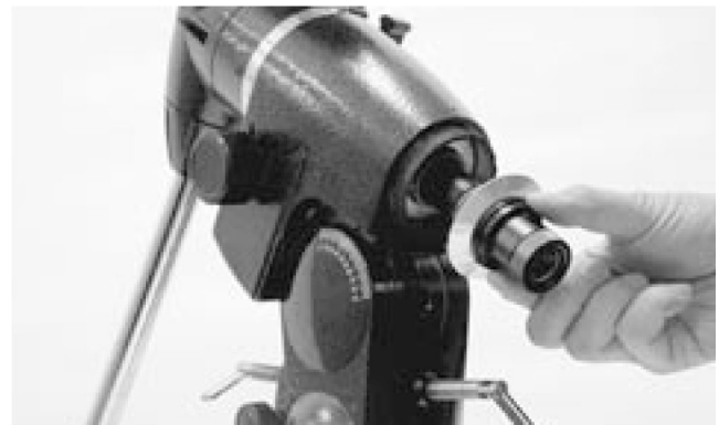
Рисунок 11б. Установка опционального полярноосевого искателя.
