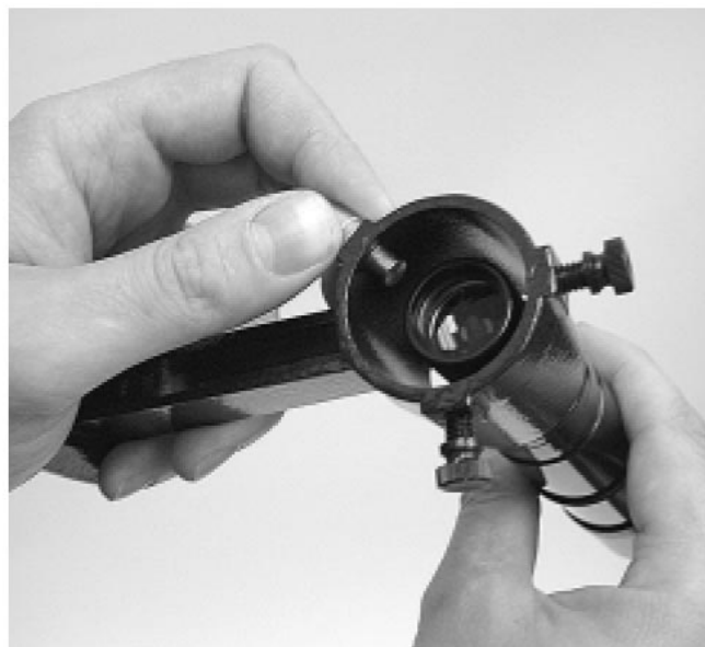
Рисунок 3б. Оттяните зажим и вставьте и скелета в кронштейн до тех пор, пока прокладка не попадет в кольцо
