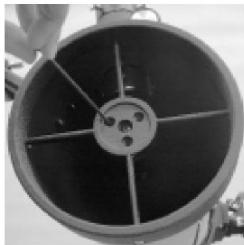
Рисунок 10. Отрегулируйте наклон вторичного зеркала ослабляя или затягивая регулировочные винты с помощью 2-мм Allen Wrench
