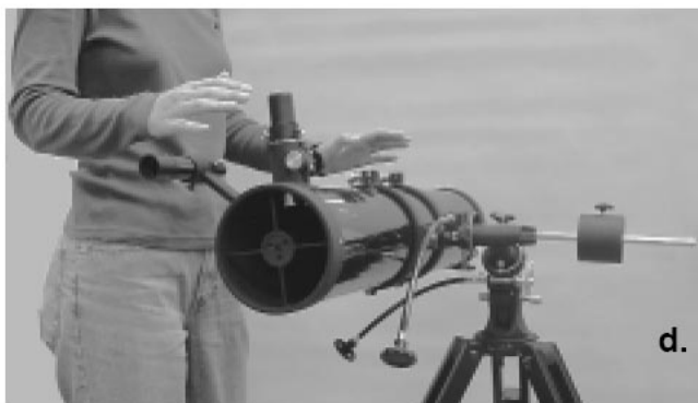
Рисунок 4а, 4б, 4с, 4д. Для правильной работы телескоп необходимо сбалансировать по осям склонения и прямого восхождения. (а) Ослабив фиксатор восхождения, сдвиньте противовес так, чтобы он уравновешивал трубу. (б) Когда Вы отпустите трубу, она не должна подниматься/опускаться. (с) Ослабив фиксатор склонения, ослабьте также зажимы колец крепления трубы и сдвиньте трубу вперед или назад. (д) Если труба сбалансирована, она сохранит свое положение, даже если Вы отпустите её.
