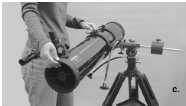
Рисунок 4а, 4б, 4с, 4д. Для правильной работы телескоп необходимо сбалансировать по осям склонения и прямого восхождения. (а) Ослабив фиксатор восхождения, сдвиньте противовес так, чтобы он уравновешивал трубу. (б) Когда Вы отпустите трубу, она не должна подниматься/опускаться. (с) Ослабив фиксатор склонения, ослабьте также зажимы колец крепления трубы и сдвиньте трубу вперед или назад. (д) Если труба сбалансирована, она сохранит свое положение, даже если Вы отпустите её.
