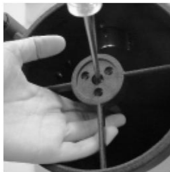
Рисунок 9. Для центрирования вторичного зеркала под гнездом окуляра, поворачивайте центральный винт, удерживая пальцами держатель зеркала. Не касайтесь поверхности зеркала.
