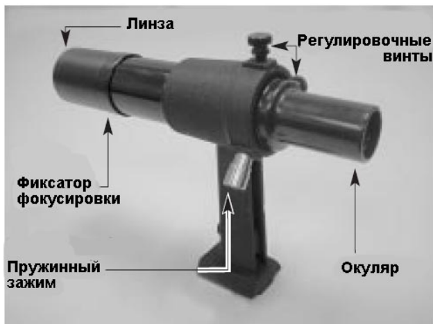
Рисунок 5. Искатель 6x30 с кронштейном
