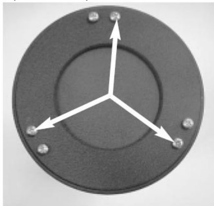
Рисунок 14. Выньте три коллимационных винта, отмеченных стрелками, для снятия зеркала.
