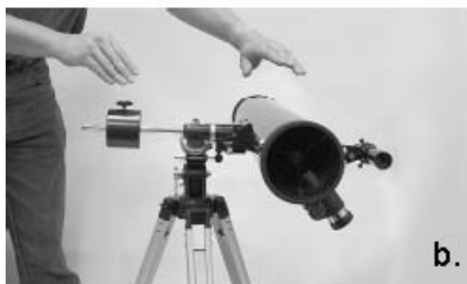
Рисунок 3. Для правильного ориентирования телескопа необходимо сбалансировать трубу на оси прямого восхождения (а). Передвиньте противовес так, чтобы он уравновесил трубу (б).
