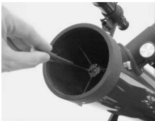
Рисунок 10. Отрегулируйте наклон вторичного зеркала, ослабляя или затягивая регулирующие винты при помощи маленькой крестовой отвертки.
