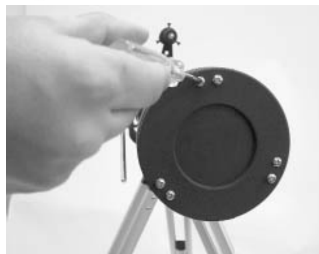
Рисунок 11. для регулировки основного зеркала ослабьте один винт на конце оптической трубы на один полный оборот, затянув второй винт "спарки" до упора.
