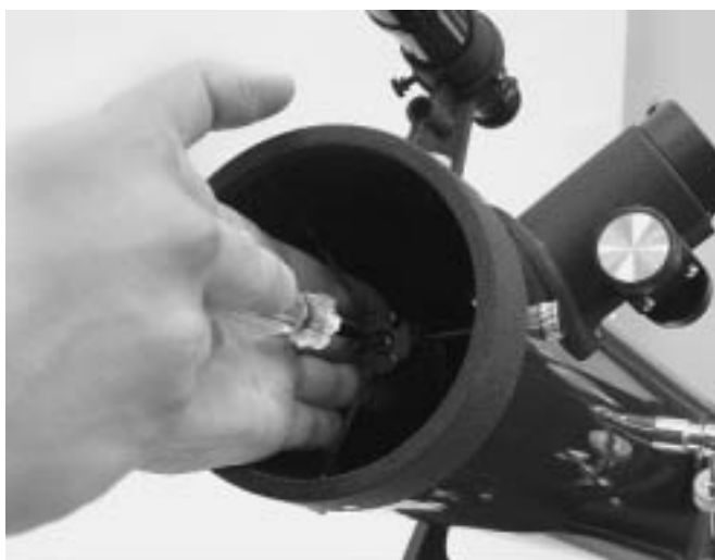
Рисунок 9. Для центрирования вторичного зеркала под гнездом окуляра, отрегулируйте большой винт при помощи крестовой отвертки, удерживая пальцами держатель зеркала. Не касайтесь поверхности зеркала.
