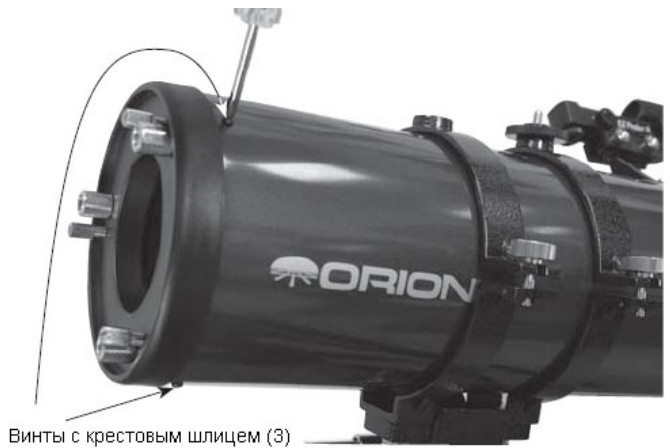
Рисунок 15. Чтобы отделить ячейку основного зеркала выкрутите три винта по периметру ячейки.
