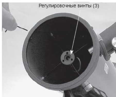
Рисунок 12. Регулировка наклона вторичного зеркала осуществляется ослаблением одного винта с одновременным затягиванием двух других
