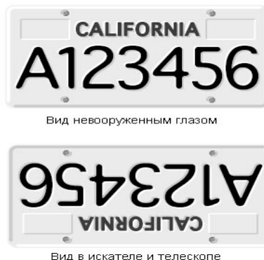
Рисунок 6. Изображение в зеркальном телескопе будет перевернутым.
