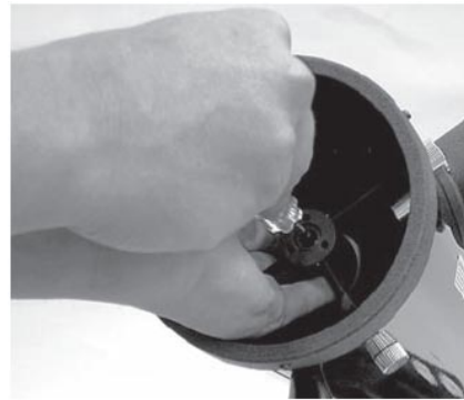
Рисунок 10. Для центрирования вторичного зеркала относительно гнезда окуляра, поворачивайте центральный винт крестовой отверткой, удерживая держатель зеркала пальцами. Не касайтесь поверхности зеркала
