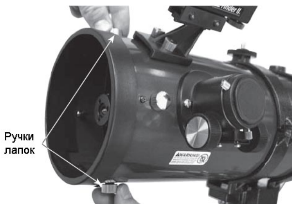
Рисунок 11. Перемещение зеркала вверх-вниз относительно гнезда окуляра осуществляется ручками лапок, перпендикулярных оси гнезда.
