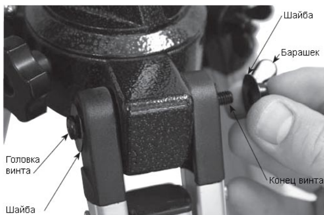
Рисунок 2. Присоедините ножки треноги к креплению винтами, установленными в вершинах ножек. Поместите одну шайбу между головкой винта и ножкой, вторая – между ножкой и барашком.
