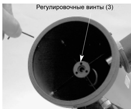
Рисунок 12. Отрегулируйте наклон вторичного зеркала, ослабляя или затягивая регулировочные винты 2 мм шестигранным.
