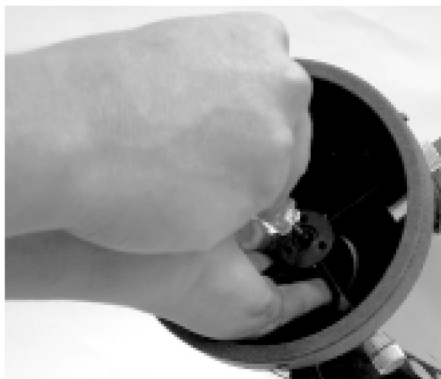
Рисунок 11. Для центрирования вторичного зеркала под фокусирующим, отрегулируйте центральный винт крестовой отверткой, удерживая пальцами держатель зеркала. Не касайтесь поверхности зеркала.
