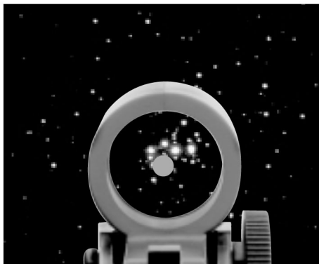
Рисунок 7. Искатель EZ Finder II накладывает красную точку на небо, точно указывая место, куда направлен телескоп.
