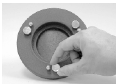
Рисунок 14. Наклон первичного зеркала регулируется поворотом одного или нескольких больших болтов.
