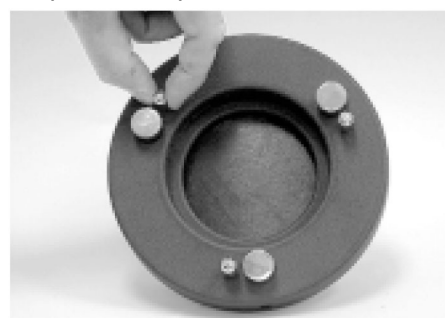
Рисунок 13. Прежде чем что-либо регулировать, сначала нужно ослабить три маленьких винта, удерживающих первичное зеркало.
