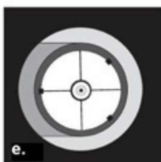
Рисунок 10. Коллимирование оптики. (а) Если зеркала выровнены надлежащим образом, Вы должны увидеть похожую картинку. (b) С установленной коллимационной крышкой, если оптика не выровнена, изображение будет выглядеть так. (с) Здесь вторичное зеркало центрировано, но требуется отрегулировать его наклон, чтобы видеть отражение первичного зеркала. (d) Вторичное зеркало окончательно выровнено, но первичное зеркало нуждается в регулировке. Когда оно будет выровнено, "точка" будет находиться точно в центре (е).
