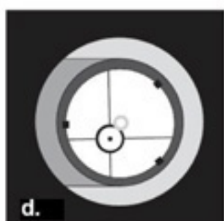
Рисунок 10. Коллимирование оптики. (а) Если зеркала выровнены надлежащим образом, Вы должны увидеть похожую картинку. (b) С установленной коллимационной крышкой, если оптика не выровнена, изображение будет выглядеть так. (с) Здесь вторичное зеркало центрировано, но требуется отрегулировать его наклон, чтобы видеть отражение первичного зеркала. (d) Вторичное зеркало окончательно выровнено, но первичное зеркало нуждается в регулировке. Когда оно будет выровнено, "точка" будет находиться точно в центре (е).
