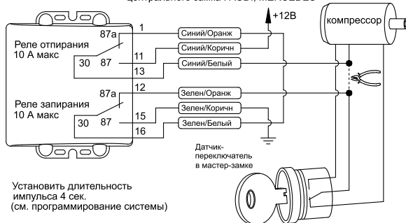
Схема подключения в автомобилях с пневмоэлектрическим компрессором центрального замка : AUDI, MERCEDES
